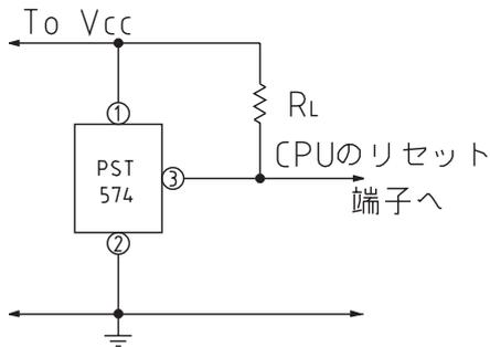
注：Vccラインのインピーダンスが高い場合は、ICの1 - 2端子間にコンデンサを接続して使用して下さい。
