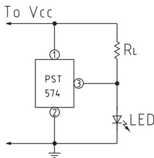
注：Vccラインのインピーダンスが高い場合は、ICの1 - 2端子間にコンデンサを接続して使用して下さい。
