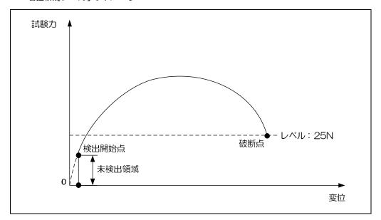
例)レベルの設定を試験力:25Nに設定した場合、 試験力が25N以下になった点を破断点とします。
