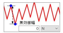
微小振幅による極大極小点の検出を無効にする幅を設定します。 試験力およびフルスケールに対する%で指定します。 設定値以上の振幅がないと極大点、極小点として検出を行いません。
