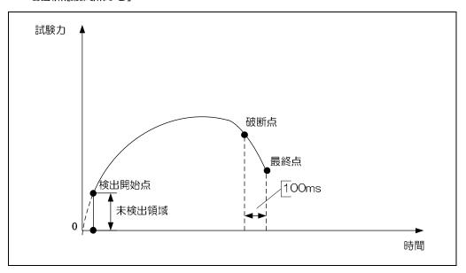
例)最終点の設定を100msに設定した場合、 最終点から時間100ms手前の点を破断点とします。
