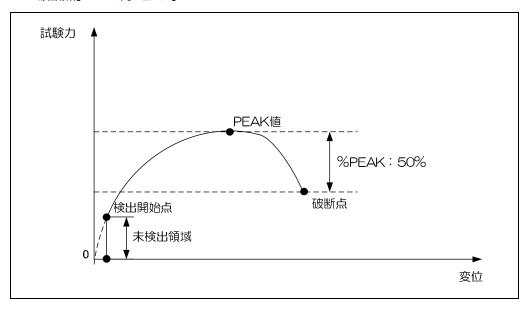
例)レベル%PEAKの設定を50%に設定した場合、 PEAK値から試験力がPEAK値の50%以下にまで落ちた点を破断点とします。
