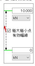
極大点、極小点の検出を有効にする幅の上下限を試験力にて設定します。
