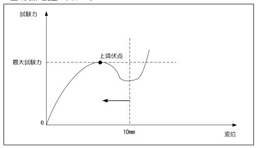
例)パラメータ1を変位:10mmと設定した場合、 変位10mmまでの最大試験力を上降伏点とします。
